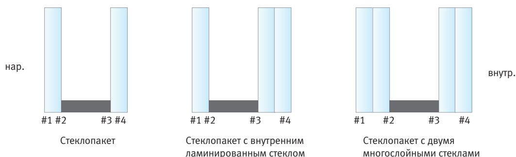
Рис. 4.3.2. Нумерация поверхностей стёкол стеклопакета (наружная поверхность расположена слева).
