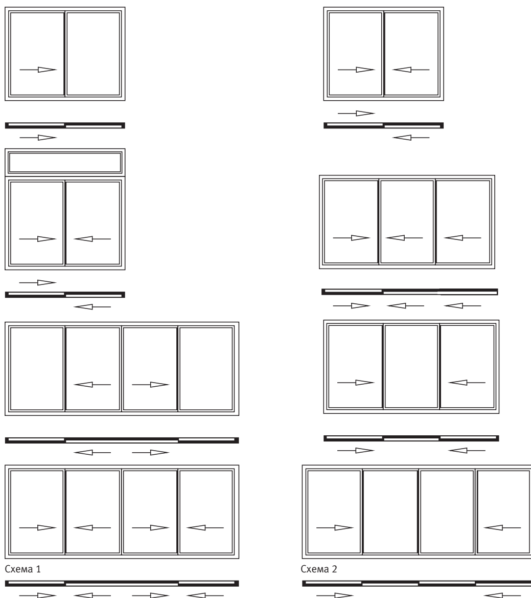
Рис. 3.2.1. Система VEKA Sunline. Возможные схемы открывания раздвижных створок.
