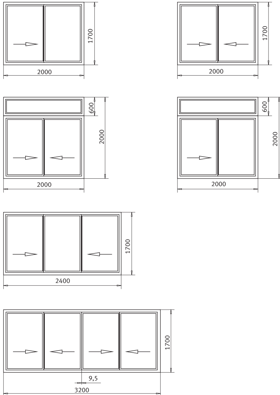
Рис. 3.2.2. Система VEKA Sunline. Ограничения по максимальным размерам элементов.
