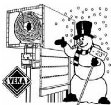
Рис. 2.1. Переменная теплоизоляция в конструкции панорамного остекления. Предотвращение избыточных теплотерь в зимнее время и перегрева летом. Рольставни VEKA, интегрируемые в оконный блок.
